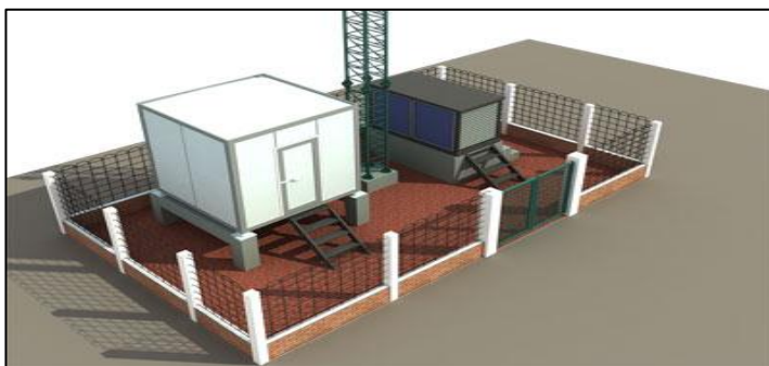
Hình 1. Hình mô phỏng một trạm BTS với trạm điều khiển độc lập
