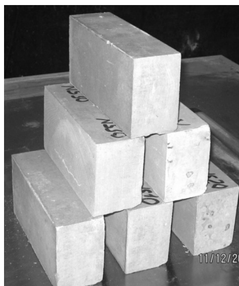
Hình 4. Mẫu gạch geopolimer tro bay sau khi chế tạo và bảo dưỡng
